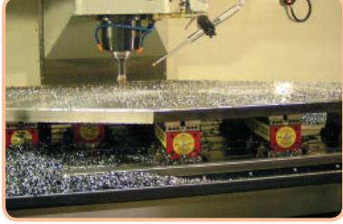
Çoklu Manyetik Blok Kullanımı ile Çok Daha Büyük İş Parçalarına Bağlama Uygunluğu Sağlar
