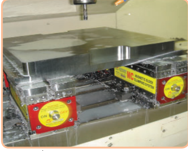
Düz Plaka İşlemlerde, Ara Boşaltmalarda, Delik Delmelerde Oldukça Pratik İş Bağlama Sistemi
