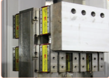
Yatay İşleme Merkezi ve Borverk Tezgahlarında Universal Yan Kafa Tezgahlarda Ağır Talaşlı İşlemlerde Ayrıca İş Kulelerinde Dik Bağlama Kolaylığı ile Montaj Alanı Bağlama Kolaylığı Sunar
